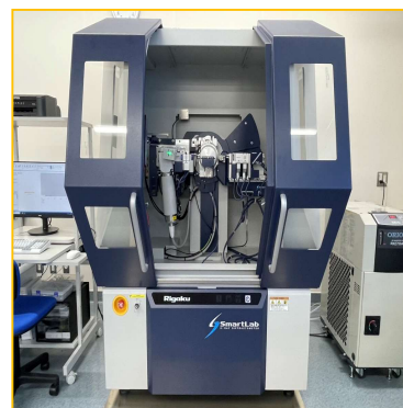
全自動試料水平型X線回折装置
